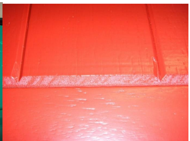
Exotique : fils du bois visible après finition
