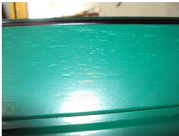
Exotique : fils du bois visible après finition
