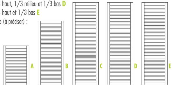
Traverse intermédiaire si hauteur remplissage > 1700 mm
