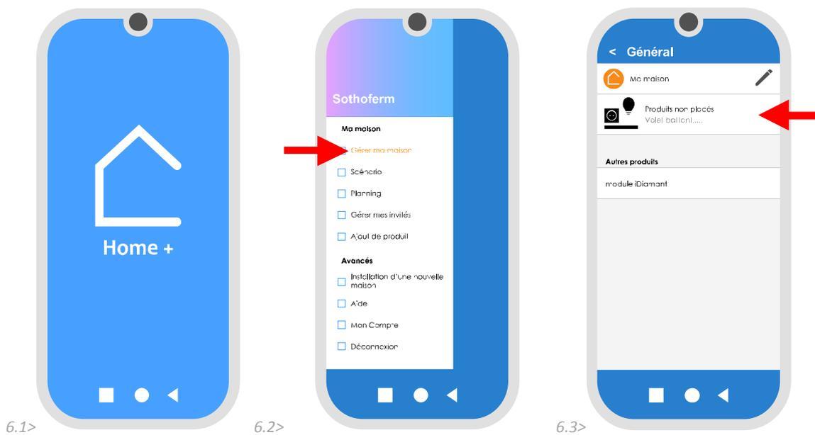
(Ils doivent être classés dans leur ordre d'appairage avec le iDiamant -> pour vérifier cet ordre un appui court sur le bouton du iDiamant (<1s) permet la fermeture de tous les volets dans leur ordre d'appairage)
