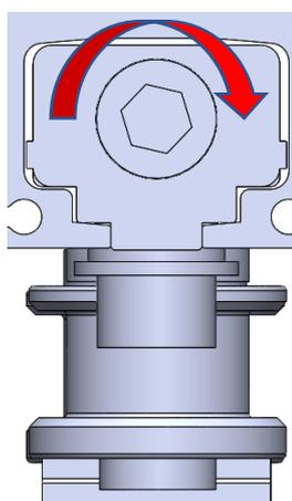
Visser pour que le bloc poulie se rapproche de la partie fixe jusqu'à une bonne tension de la courroie.
