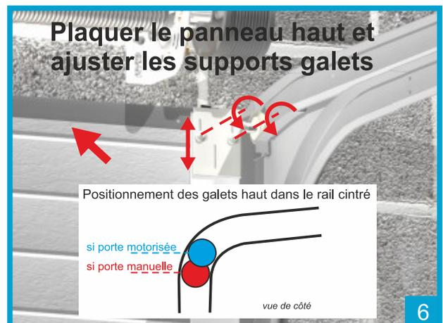
**Ajuster les galets de sorte que les panneaux plaquent sans trop écraser les joints verticaux**
