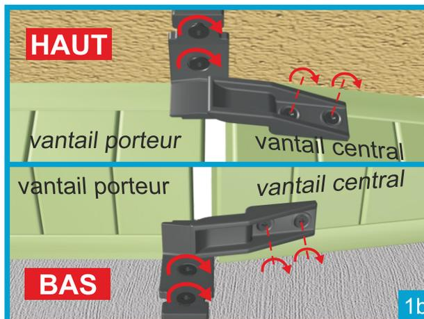
Pour répondre à la norme 13659, les vis-pentes doivent être rendues indémontables après la pose
