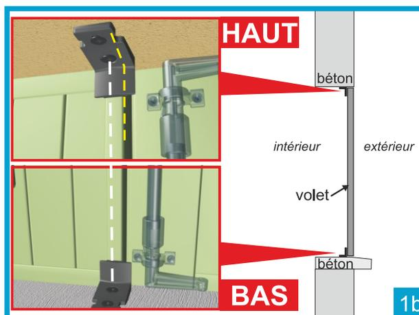
Pose des crochets de rappel pour volets repliables bois
